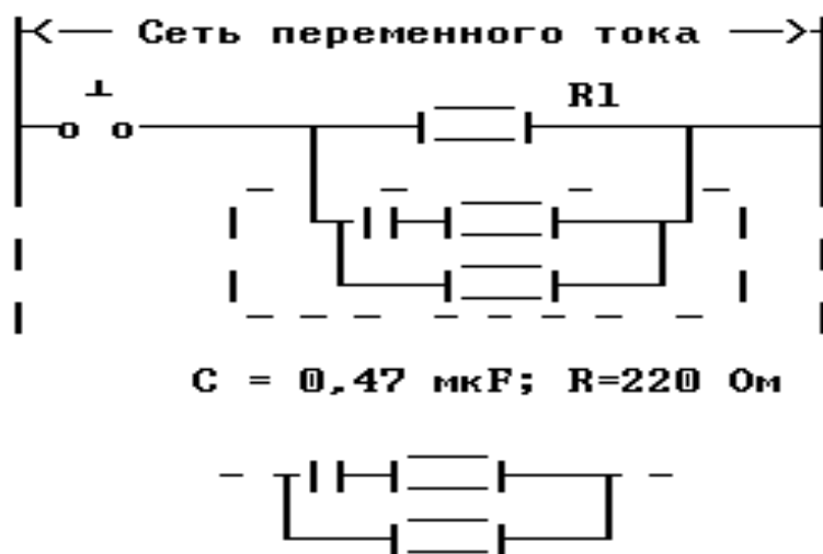
Рис. 2.37. Типовой вариант подавления электрических помех в индивидуальной нагрузке большой мощности.
