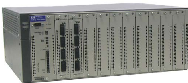
Рис. 2.17. Внешний вид многопортового коммутатора HP ProCurve Switch 8000M.
