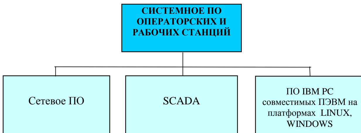
Рис. 3.15. Структура системного ПО операторских и рабочих станций.
