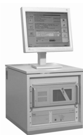
Рис. 2.30. Шкаф: размещение мониторов, системных блоков и сетевого оборудования.
