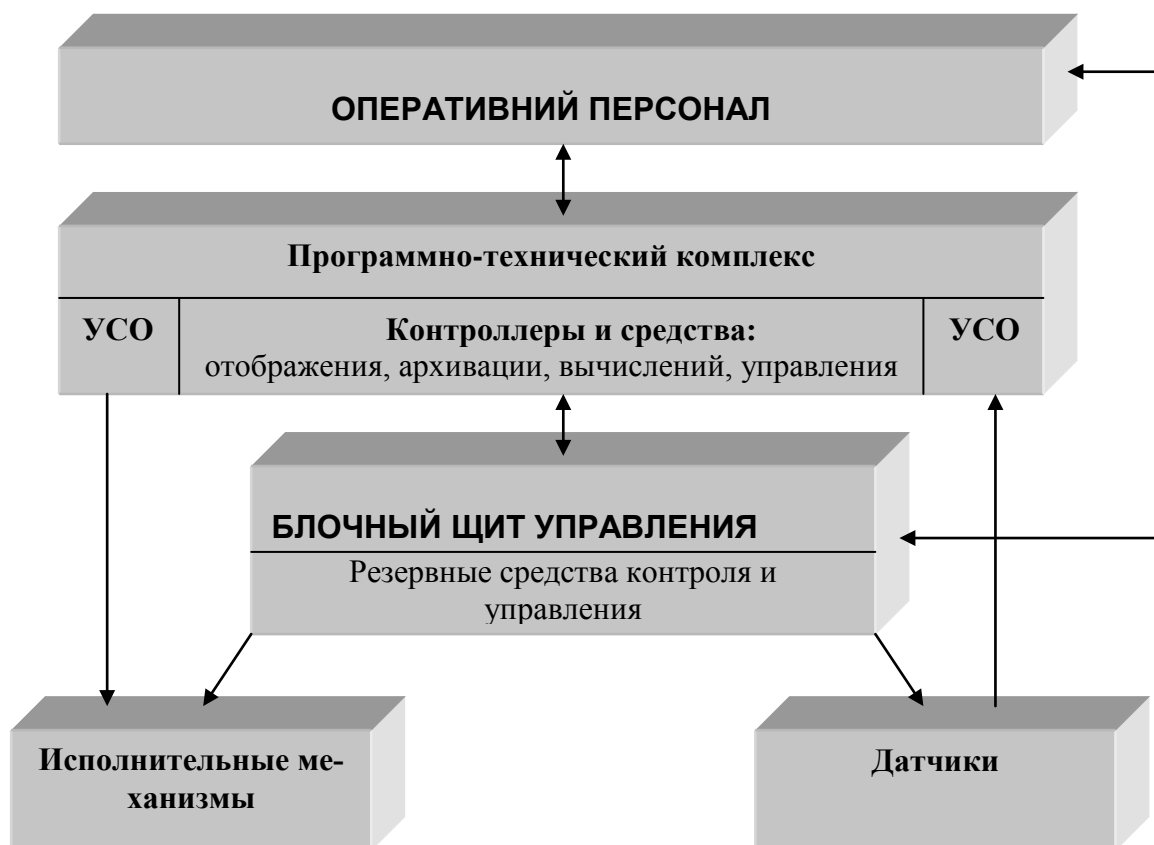
Рис. 1.1. Обобщенная структурная схема АСУ ТП.
